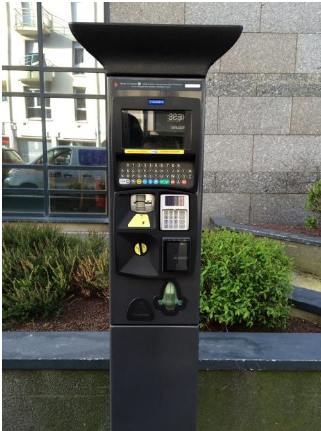
Exemple d'un horodateur mis en place parmi les 177 horodateurs nouvelle génération déployés par EFFIA à Saint-Malo.
